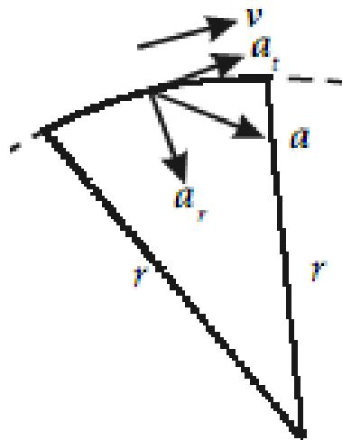
Titik P yang bergerak melingkar mengalami percepatan linear (a) yang terdiri atas percepatan tangensial ( $a_t$ ), percepatan sentripetal ( $a_s$ ), dan percepatan sudut ( $\alpha$  ).
