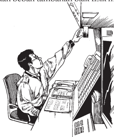
Gambar 18.1. Gerakan Menjangkau Berlebihan Karena Letak Alat Kontrol Tidak pada Daerah Jangkauan Optimum
