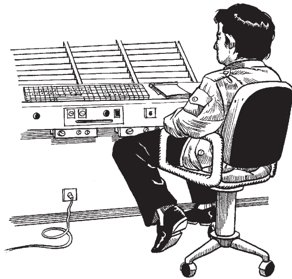
Gambar 18.4. Penempatan Alat Kontrol di Bawah Meja yang Sering Membentur Lutut serta Gambaran Kompleksitas Displai yang Harus Dioperasikan
