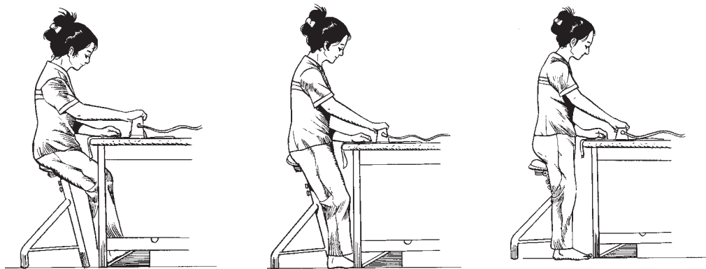
Gambar 12.7 Tampak Samping Sikap Kerja Duduk-Berdiri Bergantian
