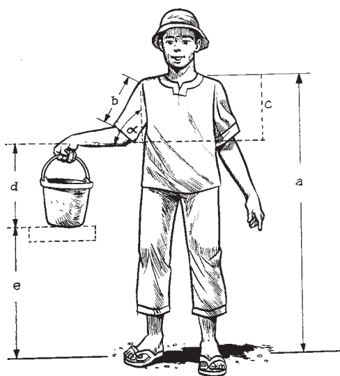
Gambar 23.4. Posisi Lengan pada Saat Mengangkat Beban.
