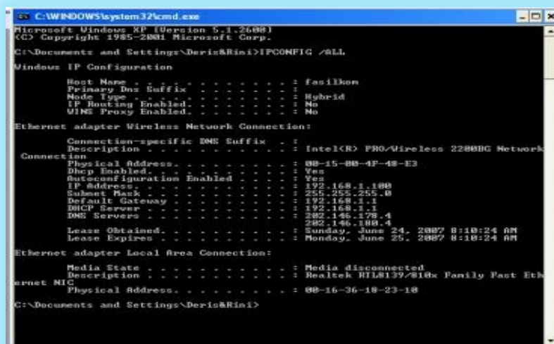
Gambar 4.42 Tampilan cmd Untuk Mengetahui Nomor MAC Address Pada Laptop / PC
