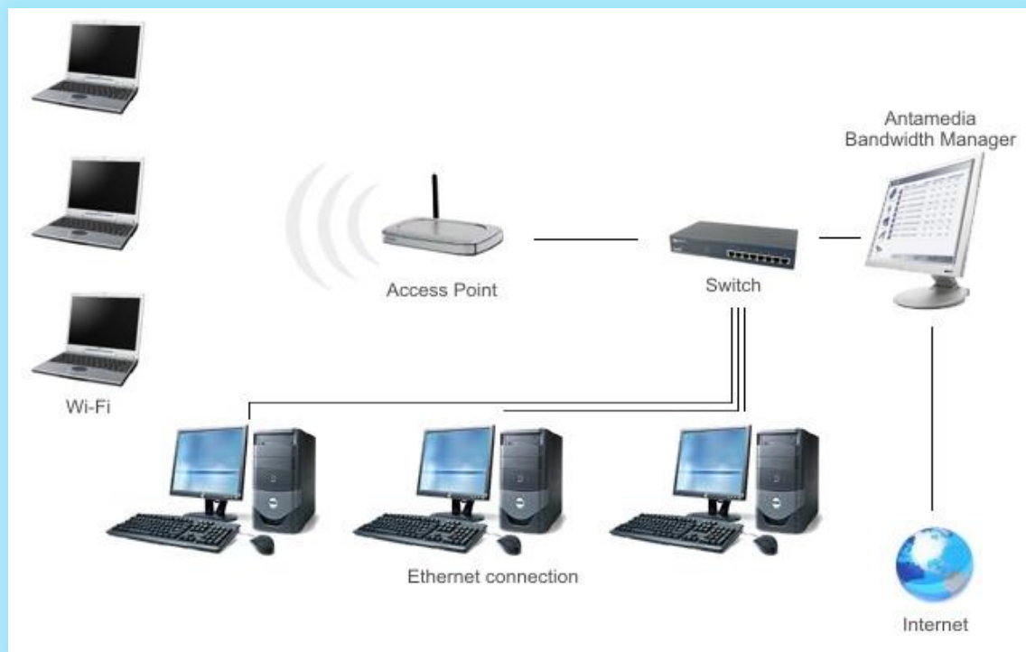
Gambar 4.28 : Mode Jaringan Wireless Infrastruktur
