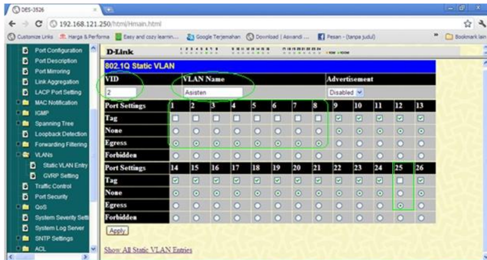
Gambar 4.22 Konfigurasi Grup VLAN (VID 2, VLAN Name Asisten, Port 1-8 & 25)
