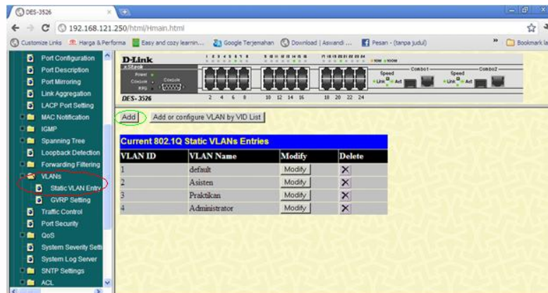
Gambar 4.21 Hasil Pembuatan dan Konfigurasi Port Pada VLAN
