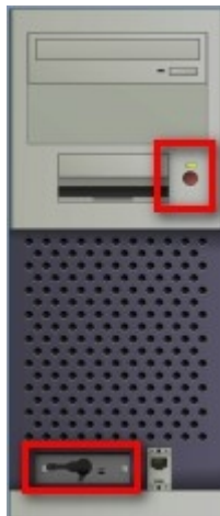
Gambar 4 : WLAN Card sudah terpasang
