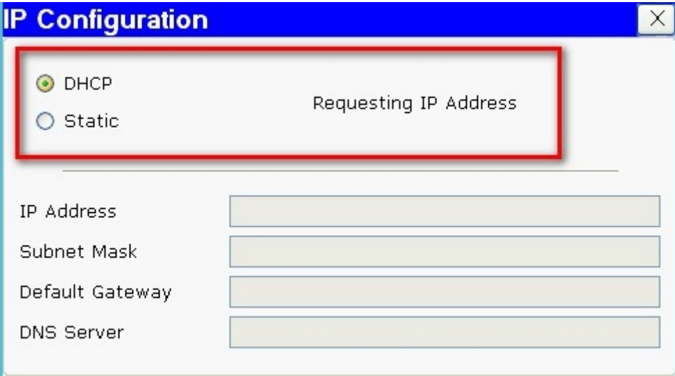
Gambar 6 : Ketika kita mengklik DHCP, disitu keterangannya adalah Requesting IP Address yang artinya dia masih meminta sebuah alamat ip pada server, tunggu saja sebentar, dan lihat hasilnya...
