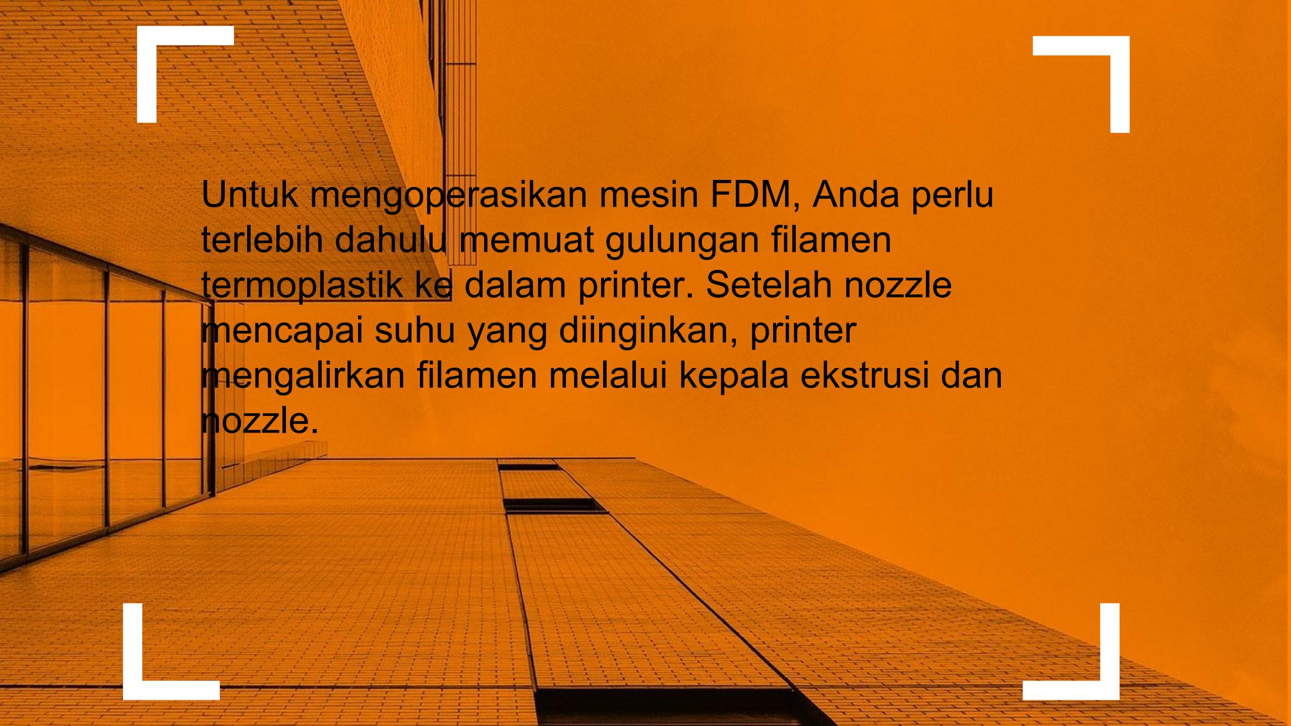
Untuk mengoperasikan mesin FDM, Anda perlu terlebih dahulu memuat gulungan filamen termoplastik ke dalam printer. Setelah nozzle mencapai suhu yang diinginkan, printer mengalirkan filamen melalui kepala ekstrusi dan nozzle.
