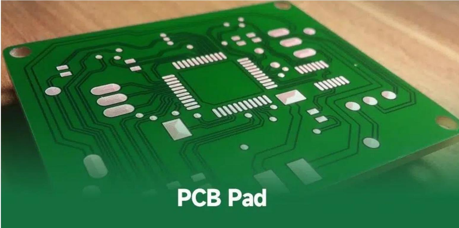
Pad atau bantalan pada PCB adalah area kecil pada PCB tempat dimana komponen elektronik dipasang atau dihubungkan. Bantalan ini menyediakan koneksi listrik antara komponen dan PCB, memastikan bahwa sirkuit berfungsi dengan baik.
